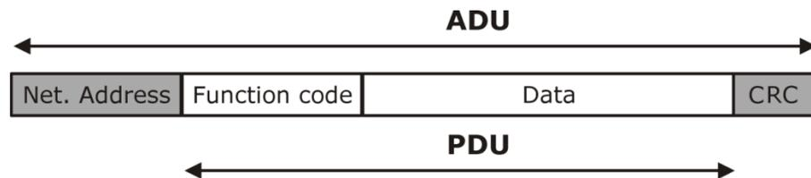
Рисунок 5: ADU для «Modbus RTU»
