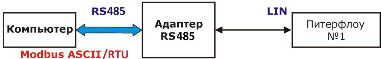
Рисунок 3: Адаптер RS-485↔Прибор
