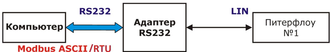
Рисунок 2: Адаптер RS-232↔Прибор
