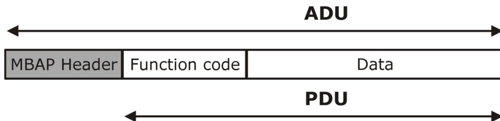
Рисунок 7: ADU для «Modbus TCP»
