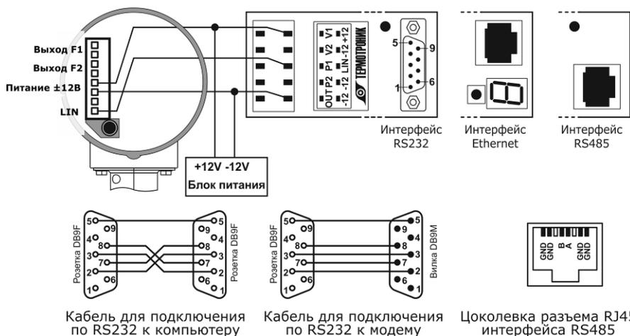
Рис. 7 – Схема подключения адаптеров RS-232, RS485, Ethernet
