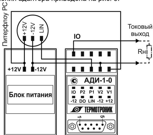
Рис. 9 – Схема подключения токового адаптера к Питерфлоу РС
